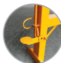
Sistema de pedal com mola
