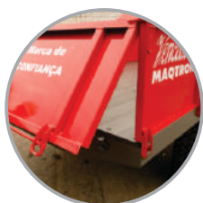
Sistema duplo de abertura da tampa traseira (superior e inferior)
