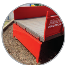
Sistema duplo de abertura da tampa traseira (superior e inferior)
