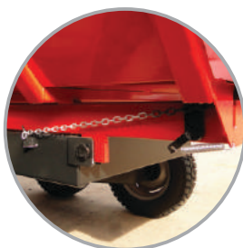
Sistema de abertura da tampa
