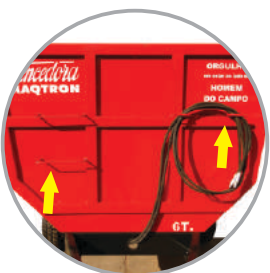
Escada e suporte para mangueiras
