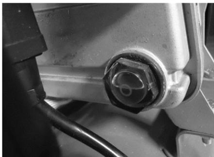
Para efetuar a troca do óleo, retire o tampão do dreno e deixe escoar todo o óleo de dentro do cárter. Após, coloque o tampão e abasteça com óleo, conforme instrução acima, verificando para que o mesmo fique no nível indicado.
