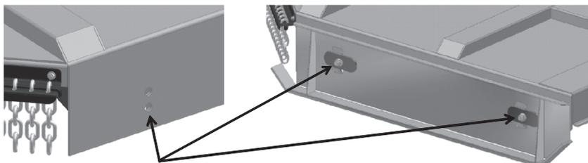
Ao alterar a altura do corte deve-se ajustar o curso dos braços do hidráulico para nivelar novamente a roçadeira; Efetue também a regulagem na roda, com objetivo de manter a uniformidade do corte.
